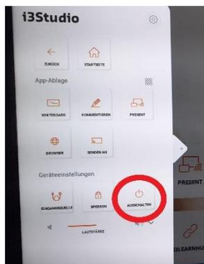
6. Wählen Sie „Ausschalten“ (ggf. „Herunterfahren“ oder „Strom“), um das Gerät herunterzufahren.
